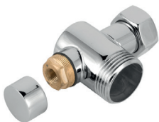
Вентиль угловой (под шестигранник) G1" нар.р. × G 3/4" н.г. Возможно исполнение с клапаном арт. 00-1300-0134
