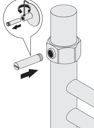
**4** Открутите стопорные винты кронштейнов шестигранным ключом №2.5, выньте шпильки и установите их в фальшгайки.
