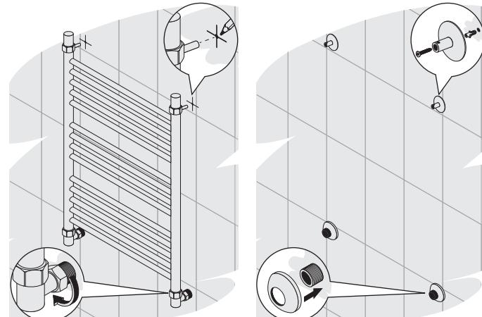
**7** Выполните примерочный монтаж: накрутите накидные гайки уголков на эксцентрики и отметьте на стене две точки для сверления.
