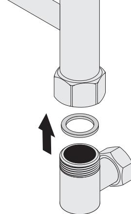
**6** В накидные гайки G 1" установите силиконовые прокладки G 1" и накрутите уголки переходные с усилием 0,6 кгс·м.<sup>2</sup>
