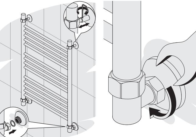
**10** Затяните накидные гайки на эксцентриках с усилием 0,6 кгс·м.<sup>2</sup>
