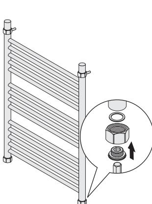
**5** Установите на коллекторы накидные гайки G 1", штуцеры<sup>1</sup> и фторопластовые прокладки.
