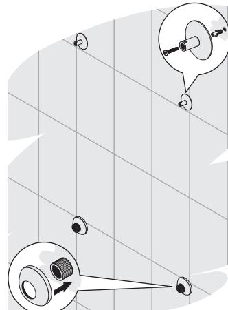
**8** Демонтируйте полотенцесушитель. Просверлите отверстия Ø 5 мм по меткам. Произведите монтаж корпусов кронштейнов и отражателей.
