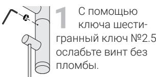
1 С помощью ключа шестигранный ключ №2.5 ослабьте винт без пломбы.
