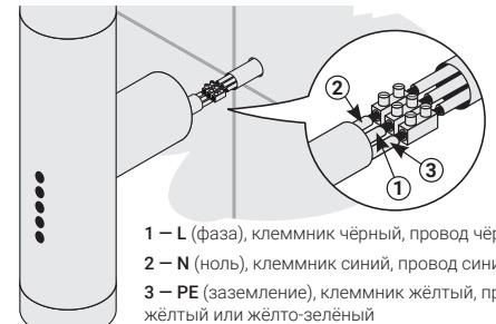
**26** Соедините провода полотенцесушителя с проводом из стены с помощью клеммных колодок. Заправьте провода в модуль скрытого подключения.
