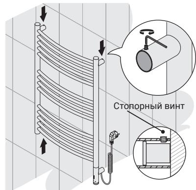
**4** Установите полотенцесушитель на все точки крепления и зафиксируйте их стопорными винтами.
