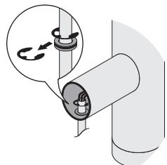
**21** Снимите шплинт-шайбу.
