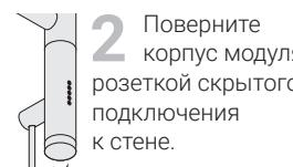
2 Поверните корпус модуля розеткой скрытого подключения к стене.
