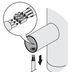
**22** Отсоедините электрический кабель от клеммных колодок и вытяните его снизу.
