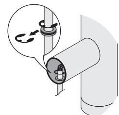
**21** Снимите шплинт-шайбу.
