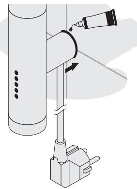
**3** Нанесите монтажный клей или жидкие гвозди<sup>1</sup> по контуру примыкания модуля скрытого подключения и стены.
