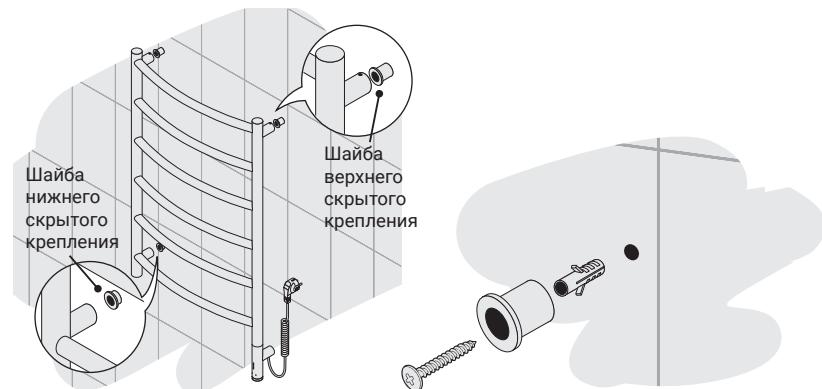
**2** В полученных метках сделайте отверстия Ø 6 мм и произведите монтаж шайб скрытого крепления к стене с помощью саморезов и дюбелей из комплекта. Для верхних креплений используются длинные шайбы, для нижнего – короткая.
