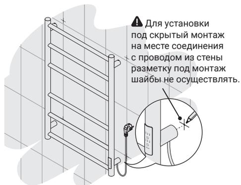
⚠ Для установки под скрытый монтаж на месте соединения с проводом из стены разметку под монтаж шайбы не осуществлять.
