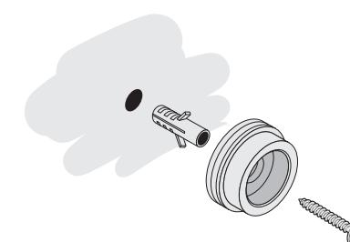
**3** В полученных метках сделайте отверстия Ø 6 мм и произведите монтаж опор к стене с помощью саморезов и дюбелей из комплекта.
