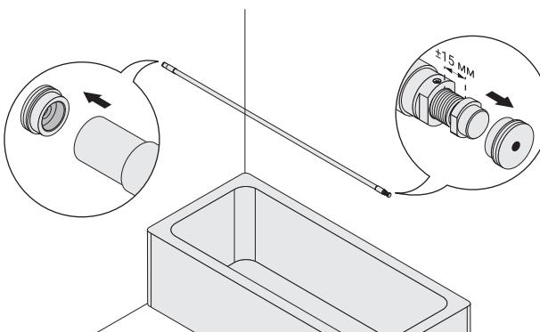
**4** С одной стороны вставьте штангу в опору, с другой – выкрутите болт до полного упора штанги.<sup>1</sup>
