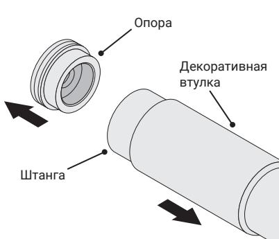
**1** Перед монтажом разберите карниз: сдвиньте декоративные втулки и выньте опоры из штанги.
