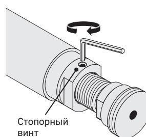
**5** При помощи шестигранного ключа №2.5 зафиксируйте болт стопорным винтом.
