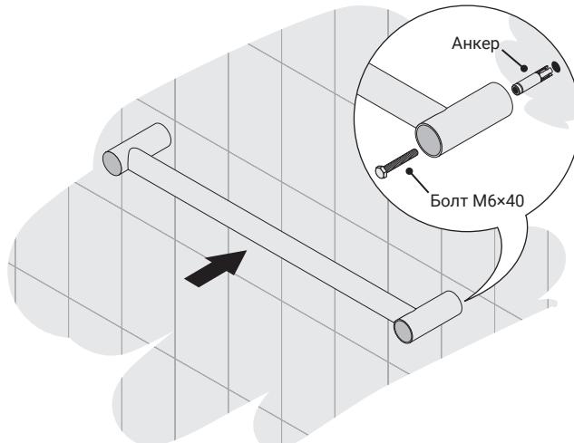
**3** В просверленные отверстия установите анкеры и при помощи болтов притяните поручень к стене торцевым ключом №10 (не входит в комплект).
