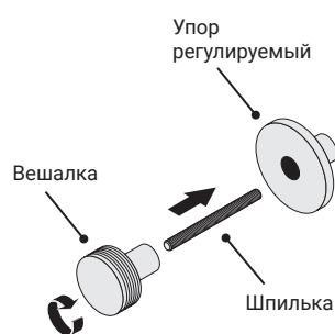
**1** Закрутите вешалку на шпильку и вставьте их в регулируемый упор.
