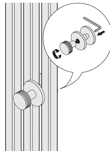
**3** Зафиксируйте аксессуар с помощью вешалки и шестигранного ключа.
