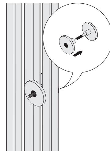
**2** Установите неподвижный упор между перемычками полотенцесушителя и наденьте регулируемый упор на неподвижный.
