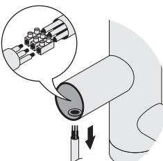
**22** Отсоедините электрический кабель от клеммных колодок и вытяните его снизу.
