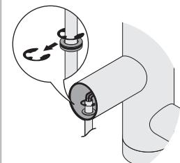
**21** Снимите шплинт-шайбу.
