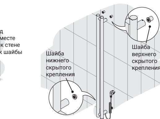
**2** В полученных метках сделайте отверстия  $\varnothing$  6 мм и произведите монтаж шайб скрытого крепления к стене с помощью саморезов и дюбелей из комплекта. Для верхних креплений используются длинные шайбы, для нижнего – короткая.
