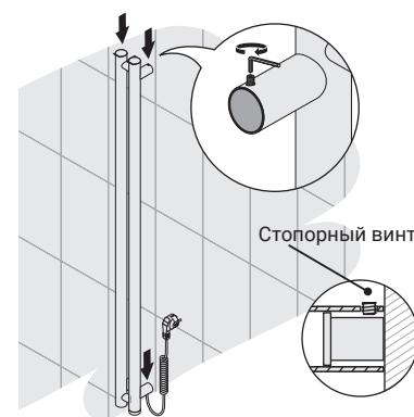
**4** Установите полотенцесушитель на все точки крепления и зафиксируйте их стопорными винтами.
