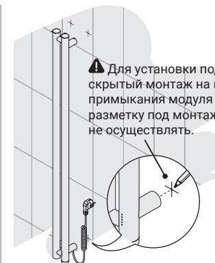
**1** Произведите «примерочный» монтаж полотенцесушителя и сделайте метки на стене. Для подключения в розетку потребуется четыре метки, для скрытого монтажа – три.
