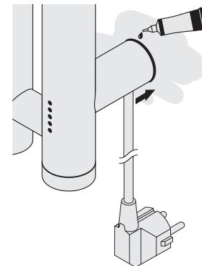
**3** Для защиты электропроводки от влаги и пыли, обработайте силиконовым герметиком место примыкания модуля к стене.
