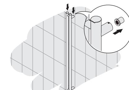
**25** Установите полотенцесушитель на верхние крепления и закрутите стопорные винты так, чтобы он мог свободно двигаться, но был зафиксирован от падения.
