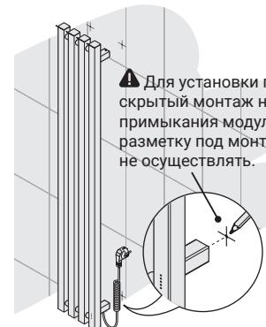
**⚠ Для установки под скрытый монтаж на месте примыкания модуля к стене разметку под монтаж шайбы не осуществлять.**
