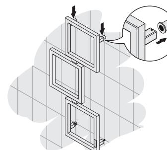
**25** Установите полотенцесушитель на верхние крепления и закрутите стопорные винты так, чтобы он мог свободно двигаться, но был зафиксирован от падения.
