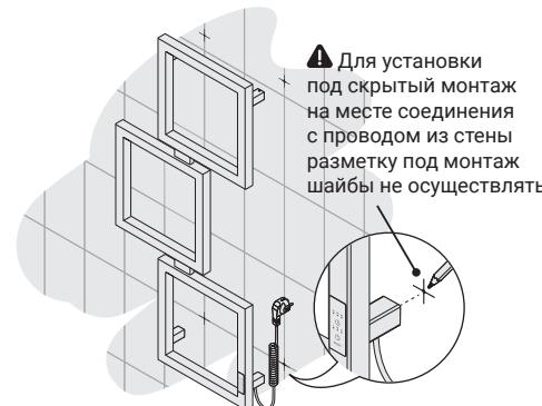
**1** Произведите «примерочный» монтаж полотенцесушителя и сделайте метки на стене. Для подключения в розетку потребуется четыре метки, для скрытого монтажа – три.
