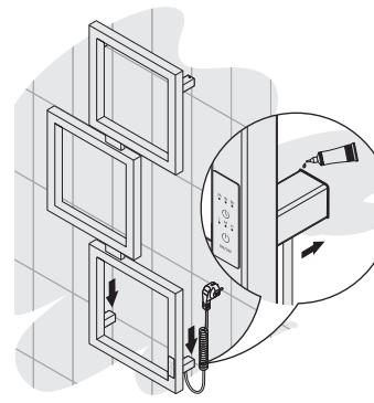
**3** Для защиты электропроводки от влаги и пыли, обработайте силиконовым герметиком места примыкания модулей к стене.
