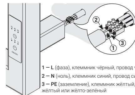
**26** Соедините провода полотенцесушителя с проводом из стены с помощью клеммных колодок. Заправьте провода в модуль скрытого подключения.
