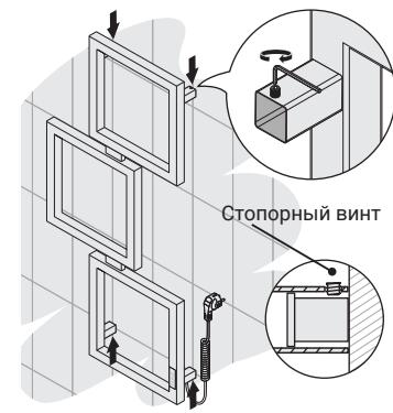
**4** Установите полотенцесушитель на все точки крепления и зафиксируйте их стопорными винтами.
