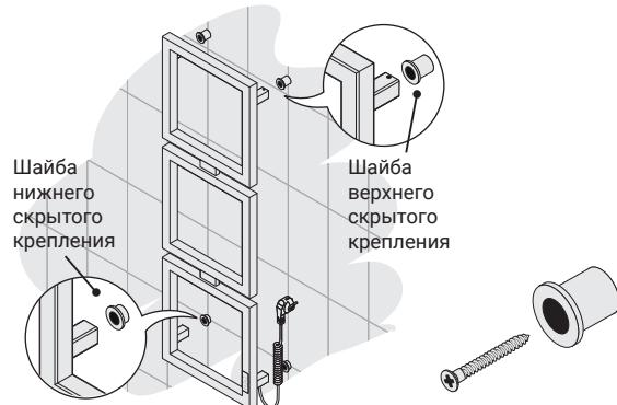
**2** В полученных метках сделайте отверстия Ø 6 мм и произведите монтаж шайб скрытого крепления к стене с помощью саморезов и дюбелей из комплекта. Для верхних креплений используются длинные шайбы, для нижнего – короткая.
