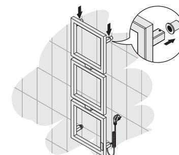
**25** Установите полотенцесушитель на верхние крепления и закрутите стопорные винты так, чтобы он мог свободно двигаться, но был зафиксирован от падения.
