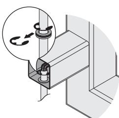
**21** Снимите шплинт-шайбу.
