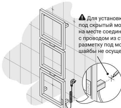
**1** Произведите «примерочный» монтаж полотенцесушителя и сделайте метки на стене. Для подключения в розетку потребуется четыре метки, для скрытого монтажа – три.
