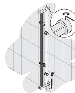
**1** Произведите «примерочный» монтаж полотенцесушителя и сделайте четыре метки на стене.
