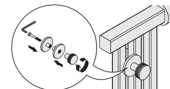
**2** Установите упор с винтом с одной стороны переключек, с другой стороны установите упор с вешалкой. Закрепите аксессуар, используя шестигранный ключ.
