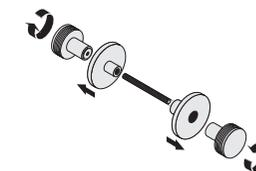
**1** Разберите аксессуар полностью: открутите вешалки и снимите упоры со шпильки.
