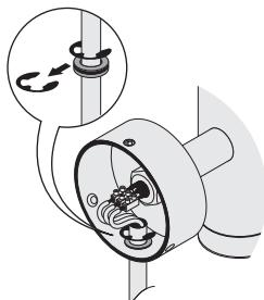
**21** Снимите шплинт-шайбу.
