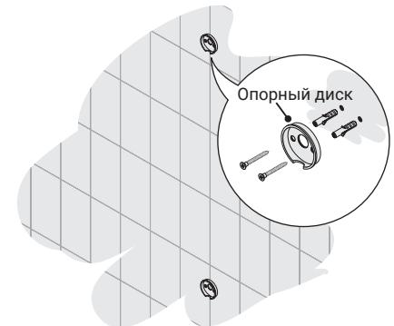
**2** В полученных метках сделайте отверстия Ø 6 мм и произведите монтаж опорных дисков к стене с помощью саморезов и дюбелей из комплекта.
