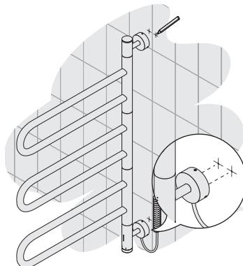
**1** Произведите «примерочный» монтаж полотенцесушителя и сделайте четыре метки на стене.
