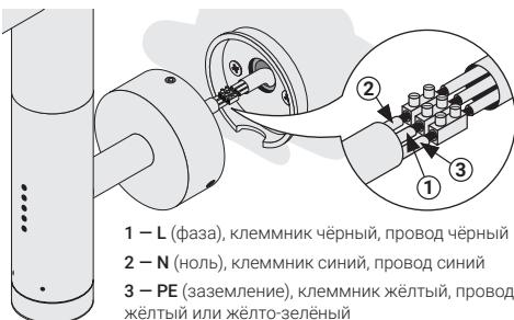
**25** Соедините провода полотенцесушителя с проводом из стены с помощью клеммных колодок. Заправьте провода в короб скрытого подключения.
