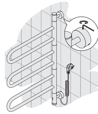
**4** Зафиксируйте все точки крепления стопорными винтами.
