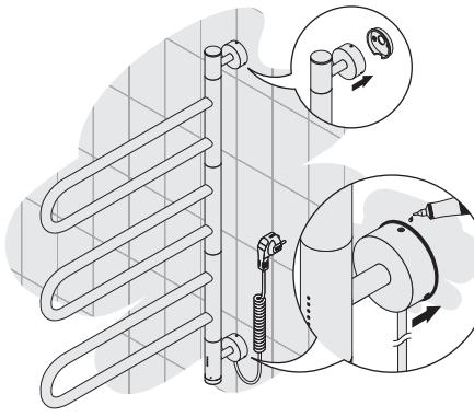
**3** Установите полотенцесушитель на опорные диски. Для защиты электропроводки от влаги и пыли обработайте силиконовым герметиком место примыкания короба к стене.
