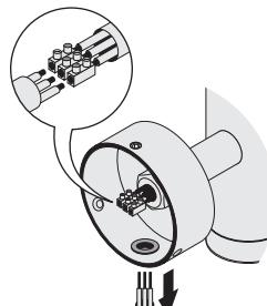
**22** Отсоедините электрический кабель от клеммных колодок и вытяните его снизу.
