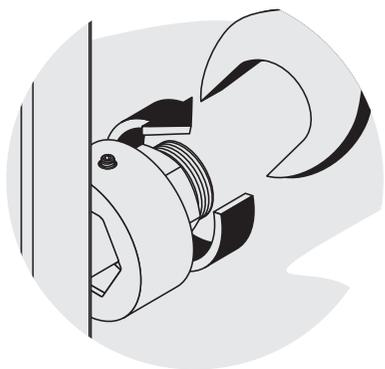
**8** Затяните гайки с усилием 0,6 кгс·м (не превышайте, чтобы избежать деформации резьбы).
