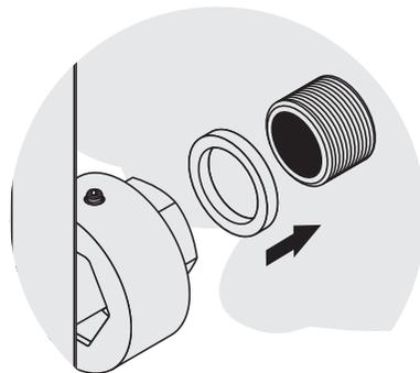
**7** Накрутите накидные гайки на эксцентрики, используя силиконовые прокладки.
