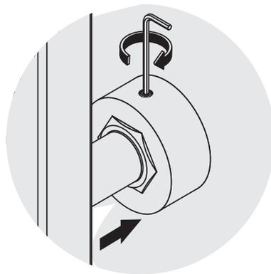
**10** Плотно прижмите отражатели к стене и закрепите их стопорными винтами (ключ №2.5).
