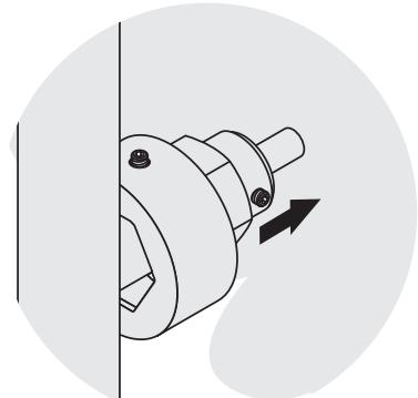
6 Установите полотенцесушитель на закреплённые в стене опоры.
