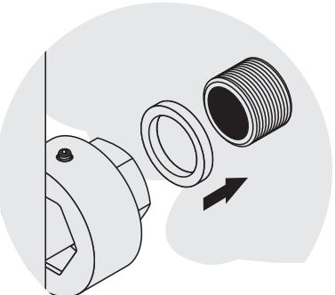
7 Накрутите накидные гайки на экс- центрики, используя силиконовые прокладки.
