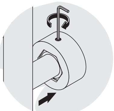
10 Плотно прижмите отражатели к стене и закрепите их стопорны- ми винтами (ключ №2.5).
