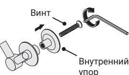
1 Перед монтажом разберите аксес- суар: открутите винт (ключ №3) и выньте внутренний упор.
