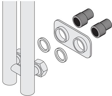
Полотенцесушитель оснащён двумя вваренными отводами с накидными гайками, предназначенными для подключения к системе водоснабжения.
