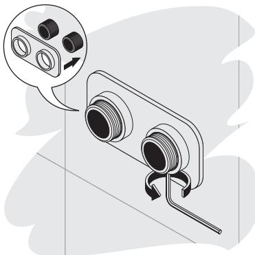
**5** Установите отражатель EU50 на эксцентрики. Зафиксируйте его стопорными винтами (ключ №2.5).
