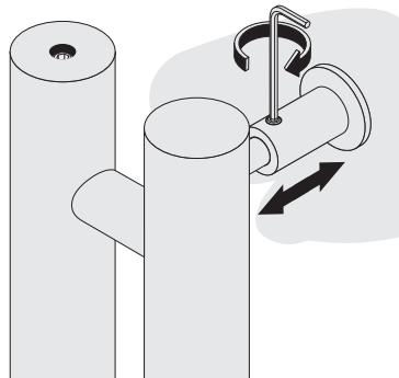
**7** Отрегулируйте глубину кронштейна и зафиксируйте его стопорным винтом (ключ №2.5).
