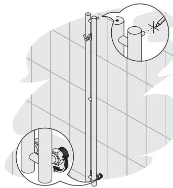
**3** Выполните примерочный монтаж: накрутите накидные гайки полотенцесушителя на эксцентрики и сделайте метку на стене.
