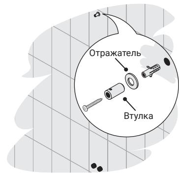
**4** Демонтируйте изделие. В полученной метке сделайте отверстие Ø 6 мм и произведите монтаж втулки с отражателем к стене с помощью самореза и дюбеля из комплекта.
