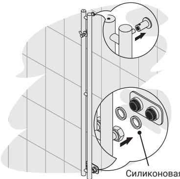
**6** Установите полотенцесушитель на кронштейн и эксцентрики, используя силиконовые прокладки.
