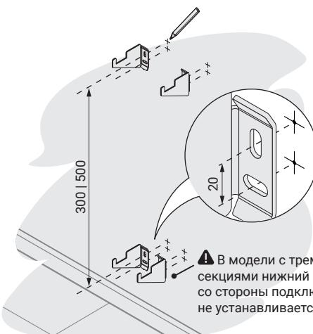
**1** Определите место для установки радиатора и нанесите на стену метки под кронштейны.
