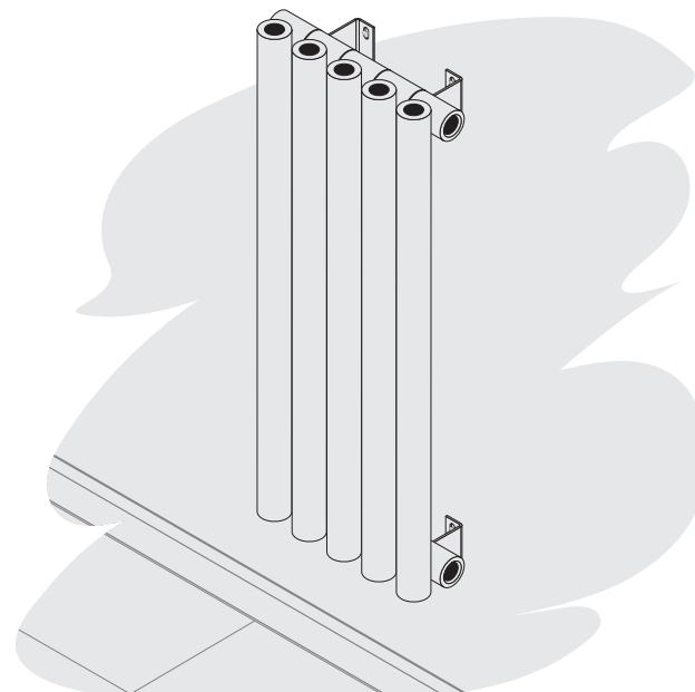
**1** Определите место для установки радиатора и нанесите на стену метки под кронштейны.
