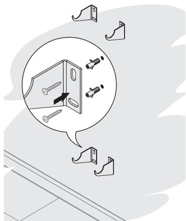
**2** В полученных метках сделайте отверстия и смонтируйте кронштейны на стену<sup>1</sup>.
