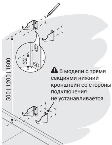
⚠ В модели с тремя секциями нижний кронштейн со стороны подключения не устанавливается.
