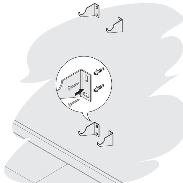
2 В полученных метках сделайте отверстия и смонтируйте кронштейны на стену<sup>1</sup>.
