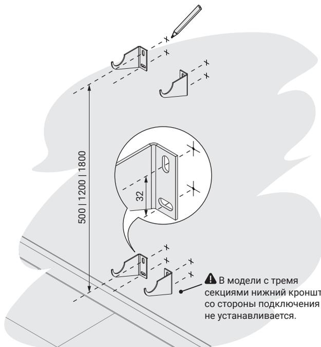
⚠ В модели с тремя секциями нижний кронштейн со стороны подключения не устанавливается.
