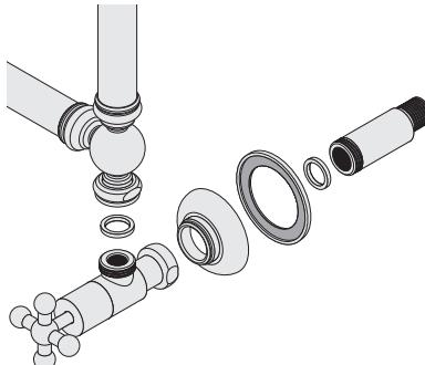
Полотенцесушитель комплектуется эксцентриками для подключения к водорозеткам ВР G 1/2".
