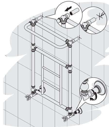
**4** Выполните примерочный монтаж: вставьте опоры в полотенцесушитель, накрутите гайки вентиляй на эксцентрики и сделайте две метки на стене.
