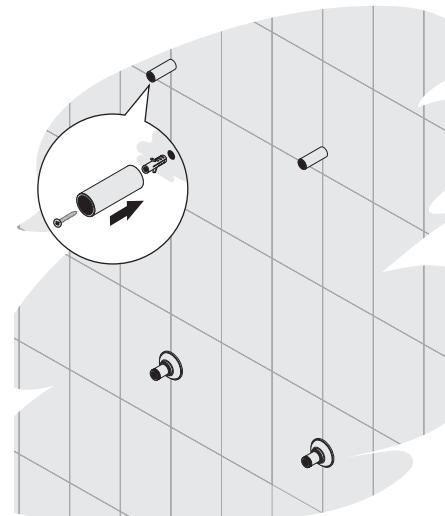
**5** Демонтируйте изделие. Просверлите отверстия Ø 6 мм по меткам. Вывнте опоры из полотенцесушителя и установите их на стену, используя дюбели и саморезы из комплекта.
