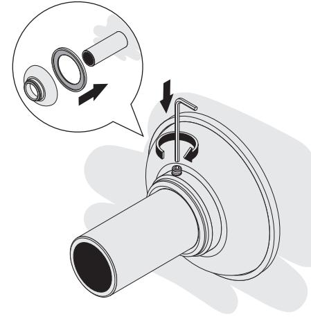
**6** Установите шайбы и отражатели на опоры. Закрепите отражатели стопорными винтами с помощью ключа №2.5.
