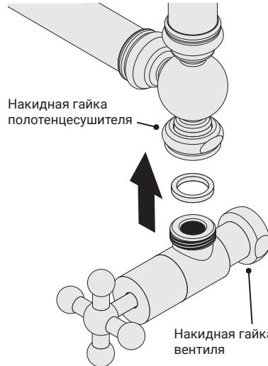
**3** Произведите установку двух вентилей, используя силиконовые прокладки. Затяните накидные гайки полотенцесушителя с усилием 0,6 кгс·м (не превышайте, чтобы избежать деформации прокладок).
