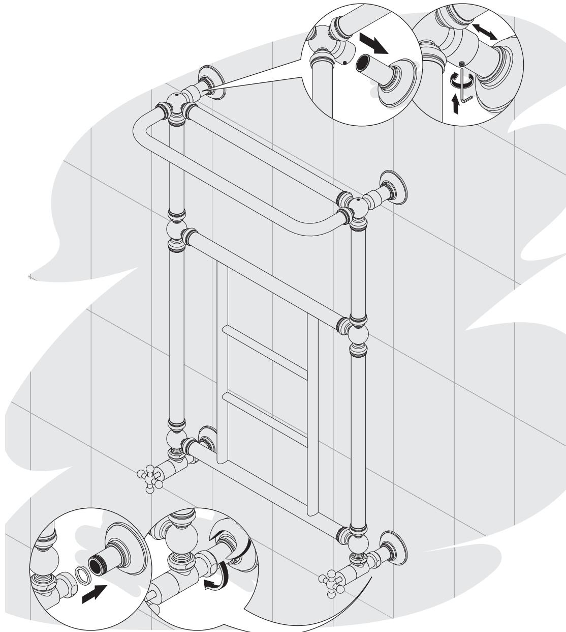
**7** Накрутите накидные гайки на эксцентрики, используя силиконовые прокладки. Отрегулируйте глубину кронштейнов и зафиксируйте их стопорными винтами (ключ №2.5). Затяните накидные гайки вентиляй с усилием 0,6 кгс·м (не превышайте, чтобы избежать деформации прокладок).
