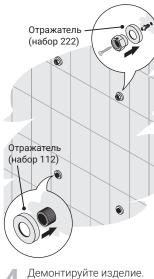
4 Демонтируйте изделие. Просверлите отверстия Ø 6 мм по меткам. Произведите монтаж фальшгаек и отражателей.
